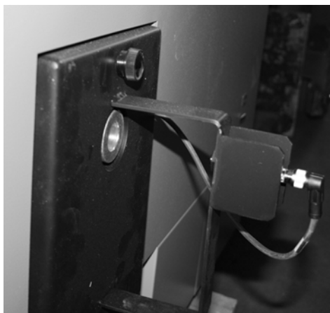
Abb. 14 Schauglas seitlich, Lichtschranke
