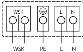
Netzanschluss 1~230 V, 50 Hz
